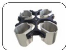
P1水平转头 最高转速：4200rpm 最大离心力：3155 × g 最大容量：200ml × 4
